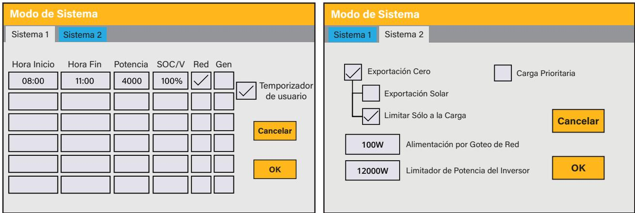
**IMPORTANTE** - Cuando cargue las baterías desde la red o el generador, asegúrese de haber configurado correctamente la carga de la batería, tal y como se muestra en la Sección "Configuración de la Batería" de la Página de Inicio. Si la función "Usar temporizador" está activada, el inversor utilizará la energía de la batería según sus ajustes cuando la red esté presente. Si esta función no está activada, las baterías SÓLO se utilizarán como respaldo cuando no haya red eléctrica.
